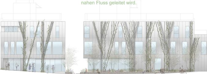
Die Fassade des Geschäftshauses wurde mit länglichen Aluminiumplatten verkleidet. Dahinter befindet sich die Stahlkonstruktion. Die Dachentwässerung wird zum dekorativen Element indem die Fallrohre gestalterisch vor der Fassade gesetzt wird. Die schmalen Rohre symbolisieren die Äste. Dazwischen gibt es Drahtgeflecht wo entlang die Pflanzen wachsen sollen.
